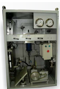
15 Painéis para controle de poços 12 volts. (10.000psi) Cliente: Petrobras Manaus.
