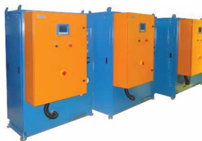
Painéis para testes com gases em tubos de aço sem costura.4 Pressões de até 7500 PSI (500 bar)
