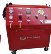
Painel de Assinatura + Unidade geradora de Pressão + Banco de Acumuladores Cliente: Tyco .
