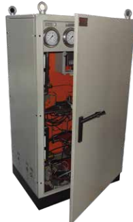
15 Painéis para controle de poços 12 volts. (10.000psi) Cliente: Petrobras Manaus.
