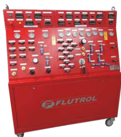
Painel de Assinatura + Unidade geradora de Pressão + Banco de Acumuladores Cliente: Tyco .
